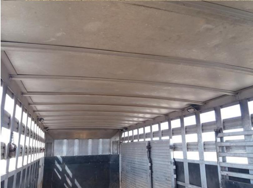
*Figura 3: Remolque con aberturas para una ventilación natural.*
