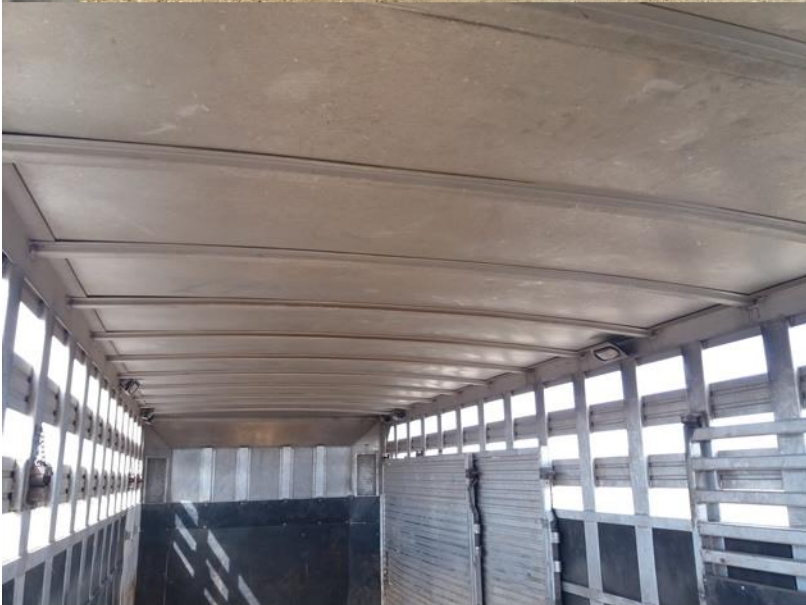
Illustration 1 : Remorque avec ouvertures assurant une ventilation naturelle.
